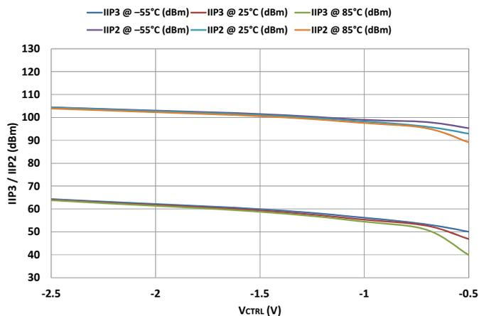
Figure 13. IIP3 / IIP2 vs.  $P_{IN}$  Over  $V_{CTRL}$
