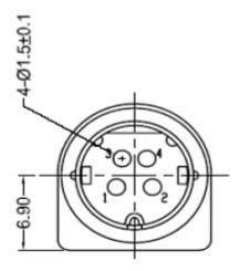
PIN2: +V PIN4:+V
