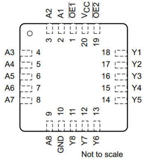
**Figure 4-2. SN54AHC540: FK Package 20-Pin LCCC
