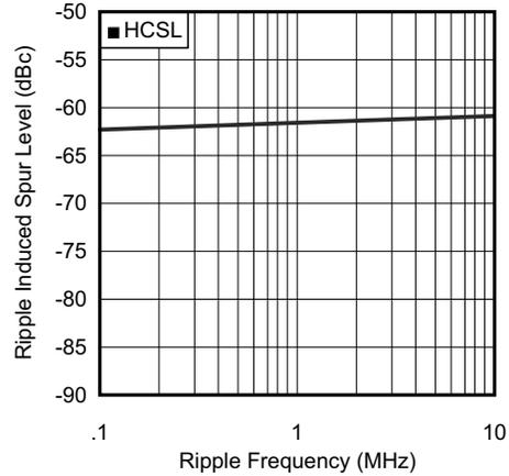
$F_{clk} = 312.5\text{ MHz}$   $V_{cc0}\text{ Ripple} = 100\text{ mV}_{pp}$
